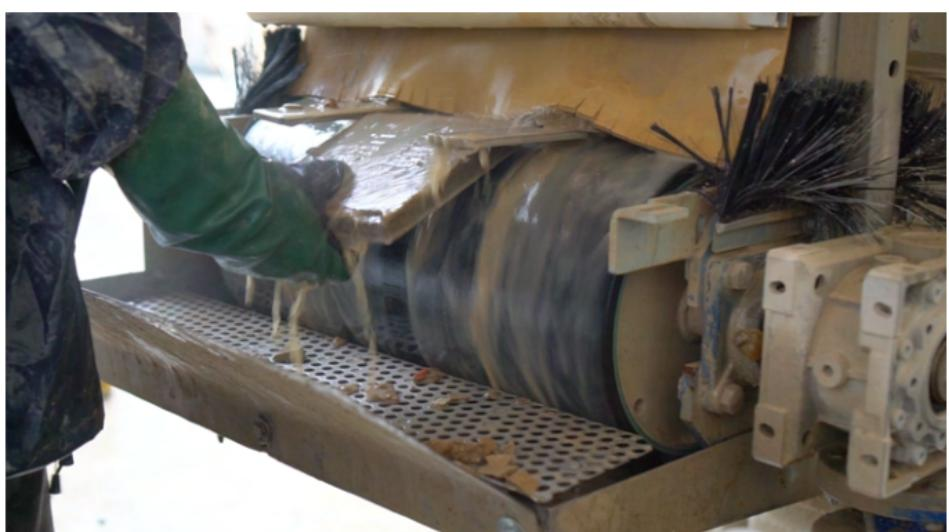
**NL** - We snijden de mortelresten aan de onderkant van de tegel mechanisch weg om het gemakkelijker te maken om de tegel opnieuw te installeren.
